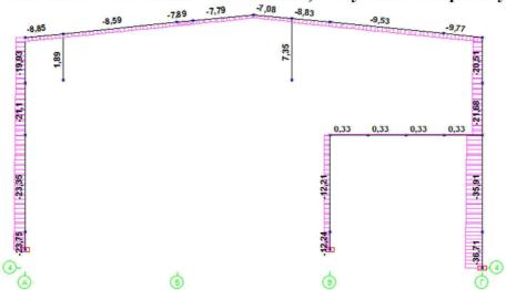
Усилия Му (L1+L2+L3+L4+L5+L6+0.9\*L8+0.9\*L9+0.9\*L12) – Му тах в опорном узле ригеля
